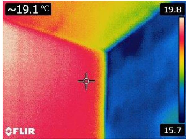
Figura 1.3 – Immagine termografica solaio
